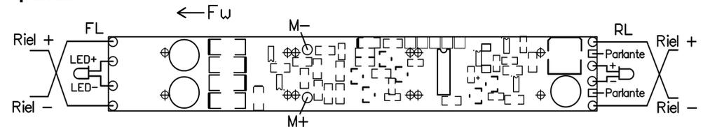
El común positivo para las funciones F5 y F6 se toma del punto de conexión LED+.
